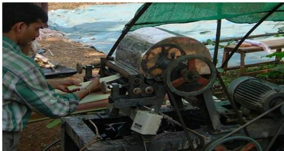
FIG 5. BANANA FIBER EXTRACTOR
